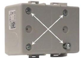
2 - A l'aide d'une pièce de monnaie, écarter la partie supérieure de la partie inférieure en utilisant l'encoche prévue à cet effet.
